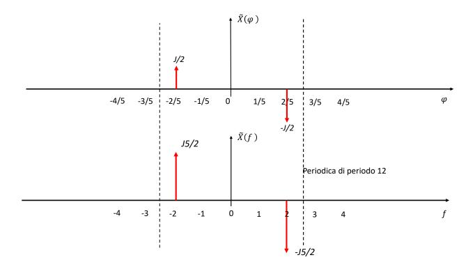
B) L'espressione della trasformata di Fourier del segnale ricostruito è:
