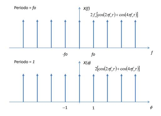
**b** – Il segnale ricostruito tramite filtro di ricostruzione ideale passa-basso nella banda  $f = \pm \frac{f_o}{2}$ Hz con ampiezza  $T = \frac{1}{f_o}$  è ovviamente una costante:
