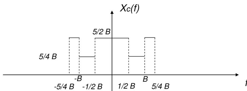
**c** – Filtrando il segnale campionato idealmente  $x_c(t)$  con un filtro passa-basso ideale di ampiezza  $\frac{2}{5B}$  nella banda  $-B < f < B$ , si ottiene una trasformata di Fourier formata dalla somma di 2 rettangoli di ampiezza  $\frac{1}{2}$  e bande rispettivamente  $B$  e  $2B$ .
