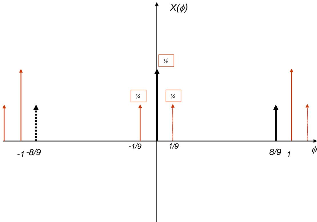
**b** – Come si vede dal punto precedente o anche semplicemente campionando il segnale continuo, il segnale discreto e' costituito da una costante  $\frac{1}{2}$  piu' una cosinusoide a frequenza normalizzata  $\frac{1}{9}$  di ampiezza  $\frac{1}{2}$ . In 36 campioni ci stanno esattamente 4 cicli di sinusoide e dunque:
