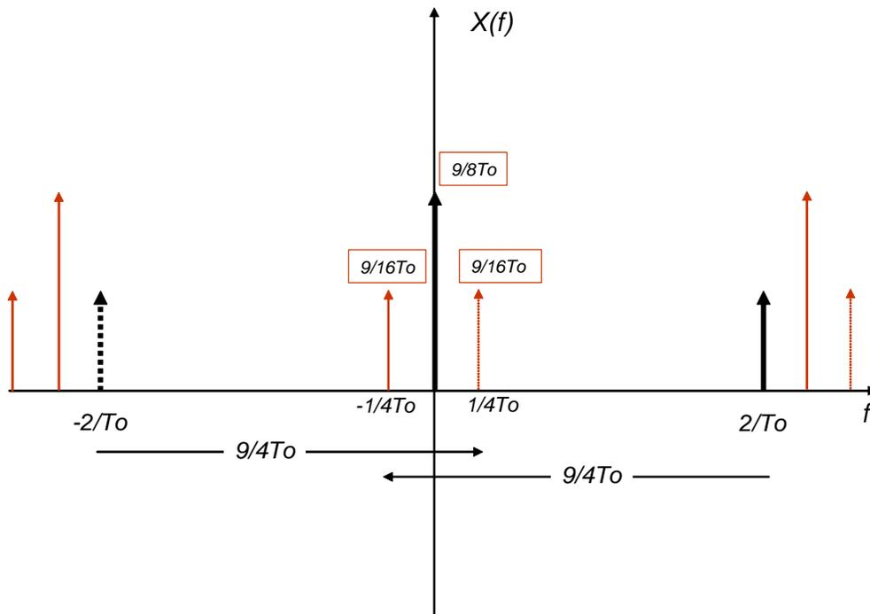
Per passare alla frequenza normalizzata e' sufficiente moltiplicare l'asse delle frequenze per  $T = \frac{4}{9}T_o$  e scalare l'area degli impulsi della stessa quantita':
