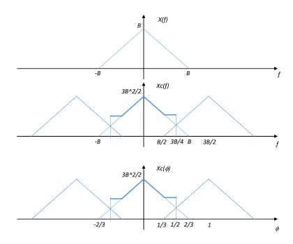
**b** — A causa delle sovrapposizioni spettrali introdotte dall'alias in frequenza, la trasformata del segnale ricostruito può essere scritta come somma di un rettangolo di banda bilatera  $\frac{3B}{2}$  e altezza  $\frac{B}{2}$  con un triangolo di banda bilatera B e altezza B. Dunque, il segnale ricostruito ha la seguente espressione:
